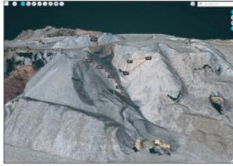
Web上で距離、体積、断面などの地形を簡単に計測ができます。
