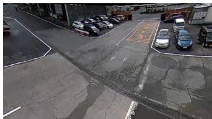
カメラ前方を常時円形で撮影、クラウド上で平面映像へリアルタイムに補正して表示できます。
