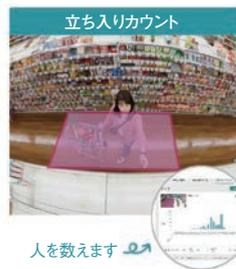
撮影する映像をカメラに搭載のエッジAIで解析。Safie Viewer上で解析結果を表示人の「立ち入り検知(立ち止まり)」「通過人数カウント(出入り)」「立ち入りカウント」の状況を、映像記録とともに人数カウント・状況記録を行えます。
