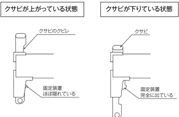
●支柱につなぎ材を取り付ける際は、クサビが上がった状態(クサビのクビレが見えている状態)で、支柱ディスクに差し込んでください。
