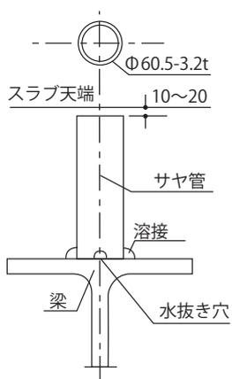
① サヤ管を梁上に溶接します。
