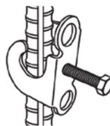
① 鉄筋に対して縦向きに鉄筋フックをはめ込みます。
