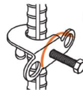
② 矢印の方向に90°回転させ、ボルトを締め込みます。
