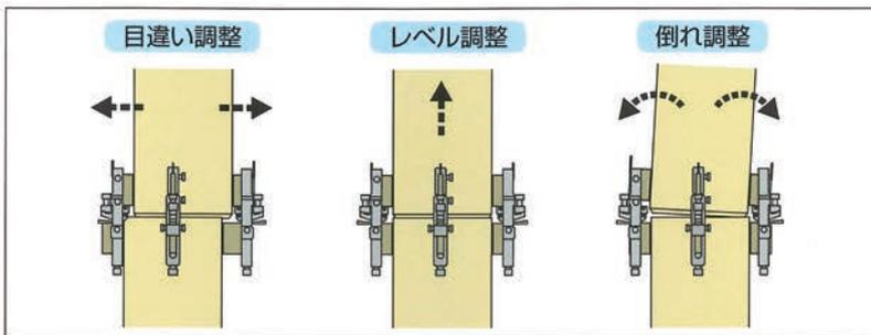
**3** 目違い調整・レベル調整・倒れ調整ができます。計測装置を使用することで高い建入れ制度を確保します。\*3次元計測装置、トランシットなどが効果的です。
