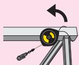
3 引き寄せロープを鉄骨柱に最初から添わせて伸ばしておき、その状態でそのまま鉄骨柱を立てます。
