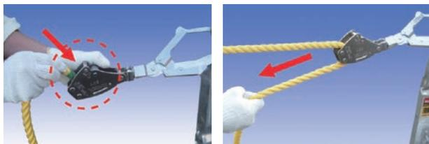
緊張器本体に刻印された矢印の方向に、親綱ロープの端末を通します。
