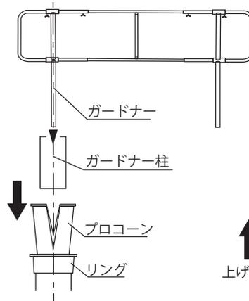
③ プロコーンのリングを下げてガードナー柱を差し込みます。
