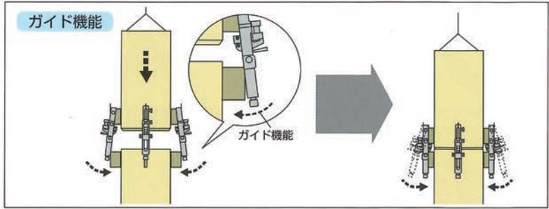
**2** 固定ボルト②を緩めることで、既設柱エレクションピースを挟み込みます(ガイド機能)次に①②の固定ボルトと③の転倒防止ボルトを締めれば転倒しません。
