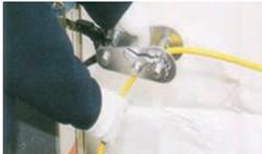
被覆ワイヤーロープの先端をドラムの四角孔に挿入する。この時被覆ワイヤーロープの先端を巻き取りドラムから50cm以上挿入する。
