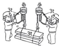
**誤** 吊り荷重3tに対して定格荷重1.5tのチェーンブロック2台での使用
