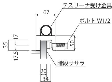
取り付け時、ササラがテスリーナ受金具の奥まで来ていることを確認し、ボルトの締め付けを行います。(ボルトの締め付け確認)
