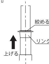
④ プロコーンのリングを上げて設置完了です。
