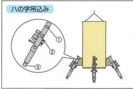
**1** 固定ボルト②を締め込み、図のようにハの字にセットします。
