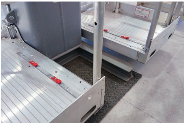
NKロータリー渡し足場板固定用金具に渡し足場を設置します
