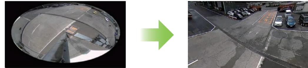
カメラ前方を常時円形で撮影、クラウド上で平面映像へリアルタイムに補正して表示できます。
