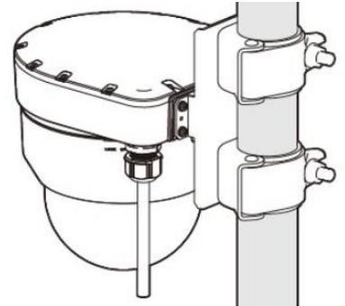
付属の金属クランプを単管パイプへ取り付け後に、防水コンセントをAC100V電源に挿すだけです。
